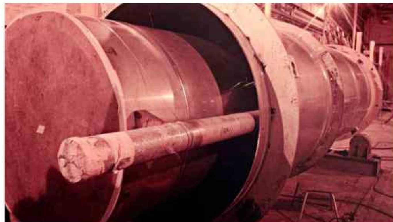
INGENIERÍA Y FABRICACIÓN DE UN TANQUE DE INOXIDABLE PARA DECAIMIENTO DE AGUA PESADA. PROYECTO RA-10. CNEA - INVAP
