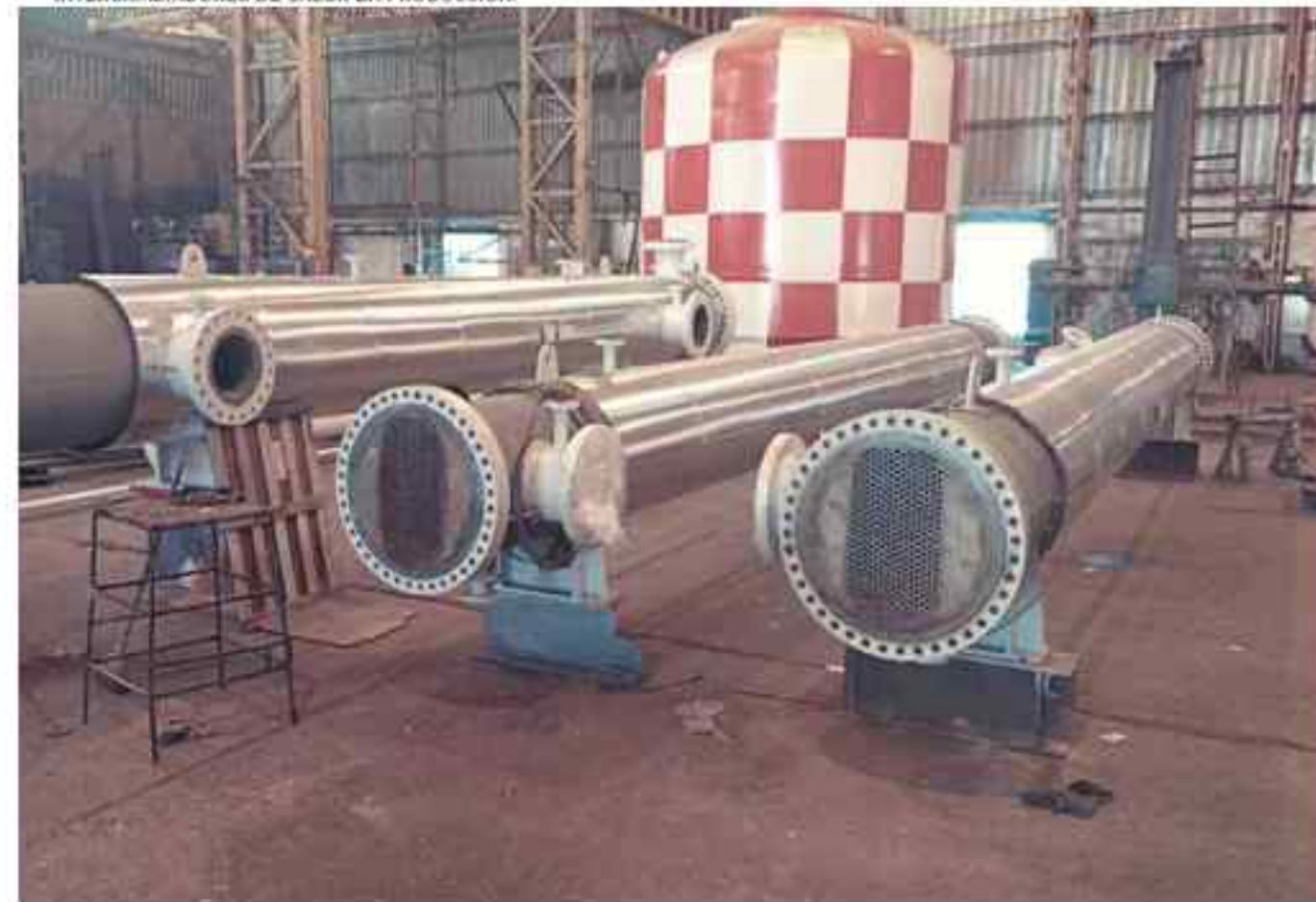
INTERCAMBIADORES DE CALOR EN PRODUCCIÓN.
