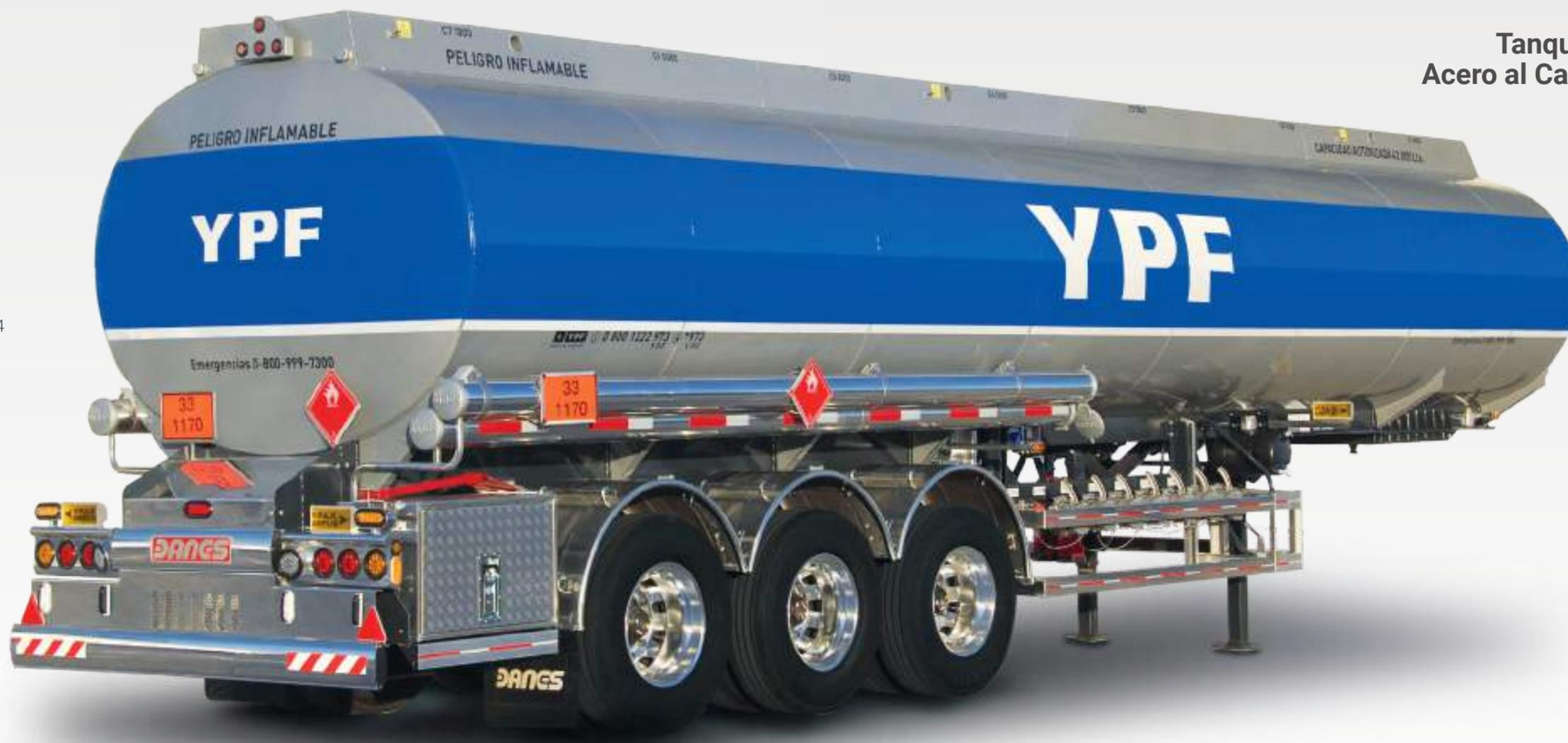
Fabricados con acero al carbono IRAM F24 y equipados con cañerías y accesorios de aluminio para máxima reducción de peso.
