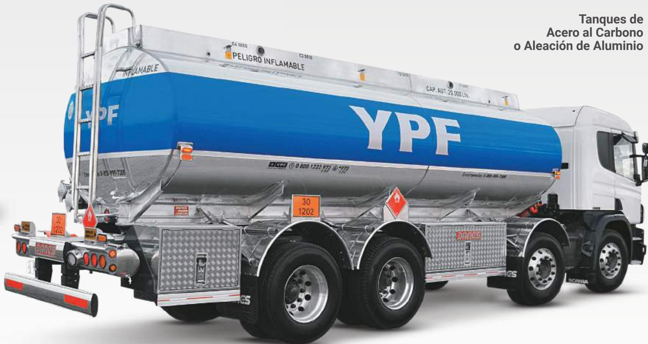
**Tanques de Acero al Carbono o Aleación de Aluminio**
