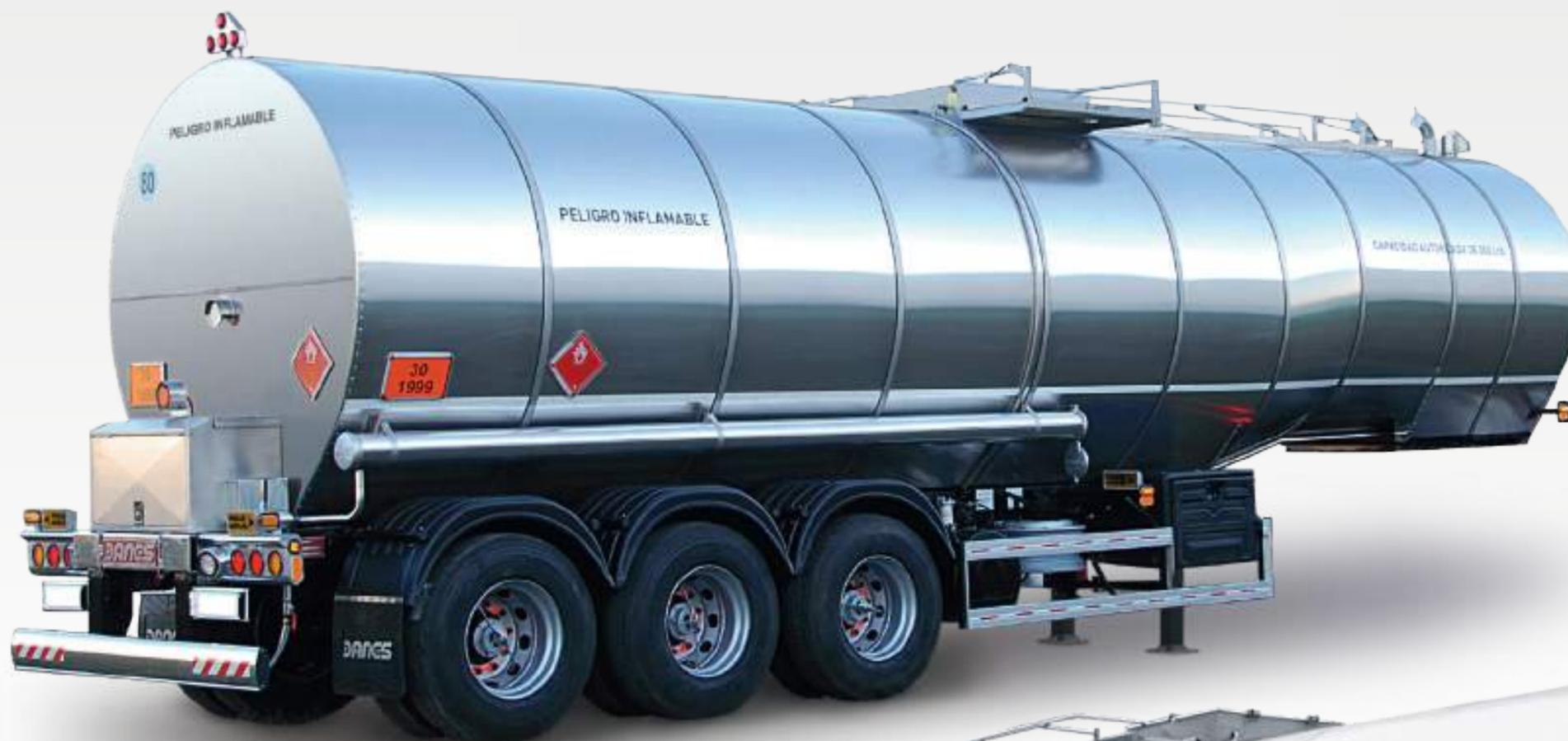
Estructura adaptada para absorber las dilataciones del tanque como consecuencia de las variaciones de temperatura.
