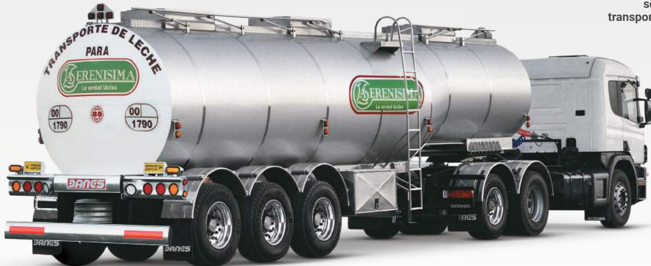
Construidos en distintas aleaciones de acero inoxidable, aislados térmicamente para productos fríos o calientes que requieran conservar su temperatura.
