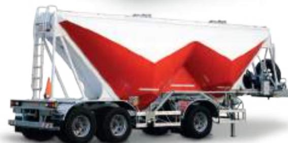
Fabricadas con acero al carbono, acero inoxidable o aleación de aluminio, con descarga por presión neumática.
