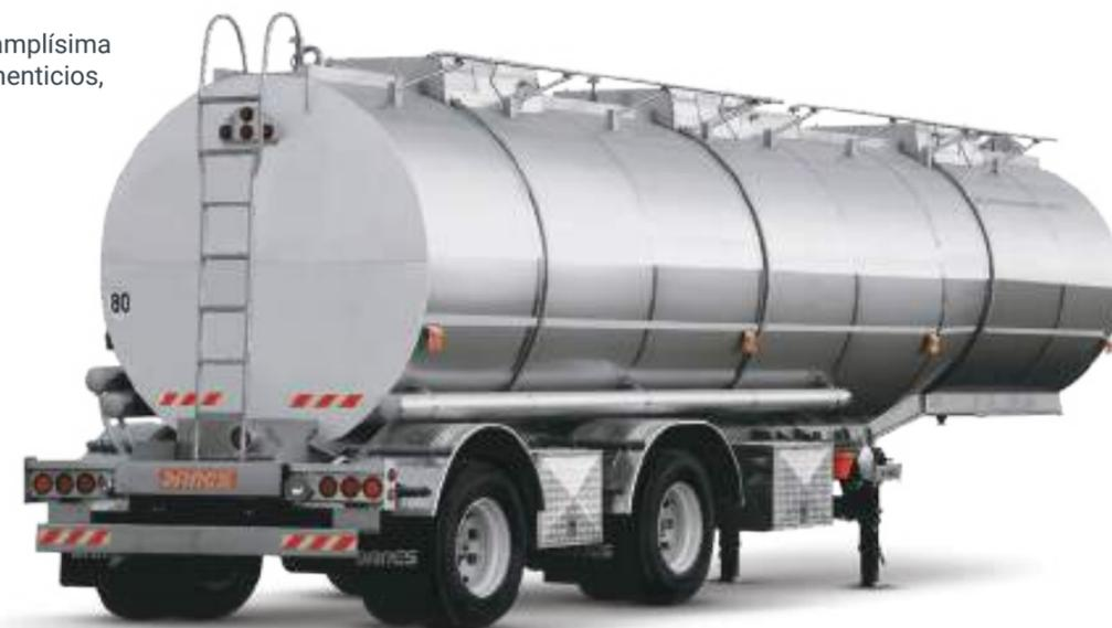
**Para transporte de cemento, cal, arena, productos alimenticios y otros pulverulentos o granulares**
