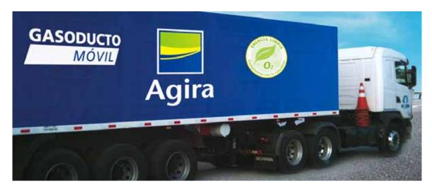
Conceptos modulables disponibles hasta 40ft Capacidades hasta 11000m3 Diseños para cargas de 200, 250 Bar Material: Composite o Acero Con aprobaciones ISO 11515 Módulos de carga y descarga
