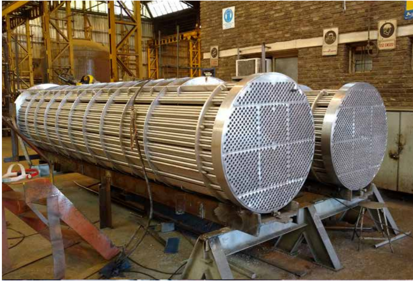
INGENIERÍA Y CONSTRUCCIÓN DE 2 MAZOS DE ALUMINIO ALLOY 3003 PARA YPF - CILP
