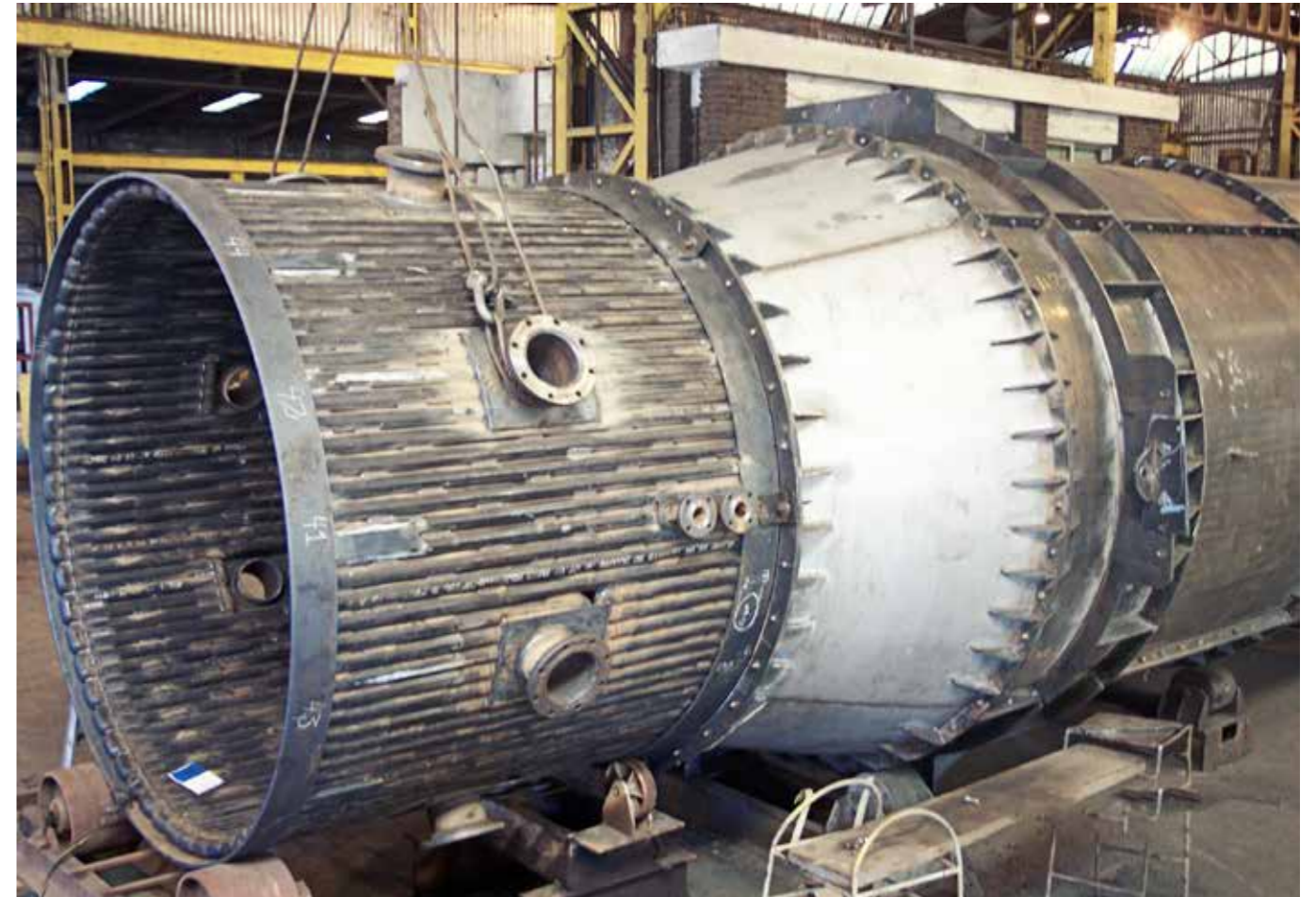
INGENIERÍA Y CONSTRUCCIÓN DE DUCTOS DE AIRE CALIENTE, REFRIGERADOS PARA ACINDAR
