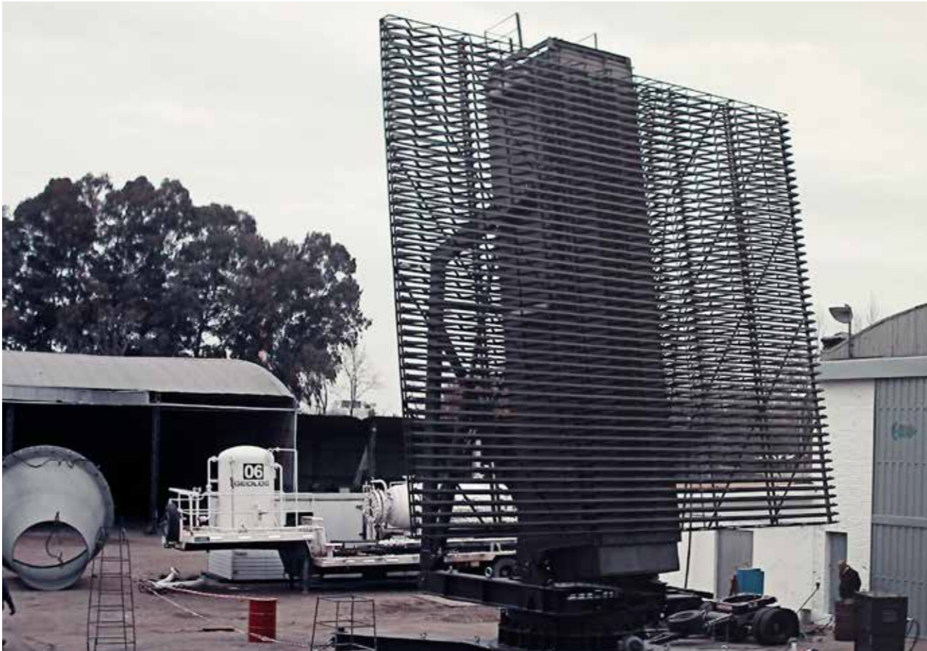
CONSTRUCCIÓN, ENSAMBLE Y PRUEBAS DE FUNCIONAMIENTO MECÁNICO DEL RADAR PRIMARIO ARGENTINO - INVAP
