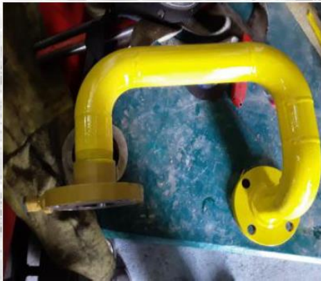
Prefabricado de cañerías para alimentación de generadores a gas natural.
