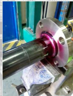
Prefabricado de spools en acero inoxidable. Ensayos no destructivos por líquidos penetrantes.
