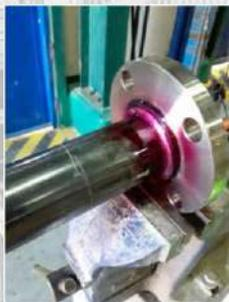
Prefabricado de spools en acero inoxidable. Ensayos no destructivos por líquidos penetrantes.
