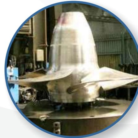
Torno Vertical Rotor Turbo Compresor Diámetro 1800 mm
