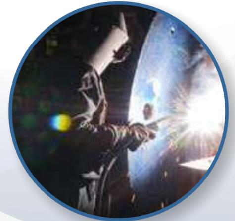
Reparación Rotor Molino Cementero 20 Toneladas
