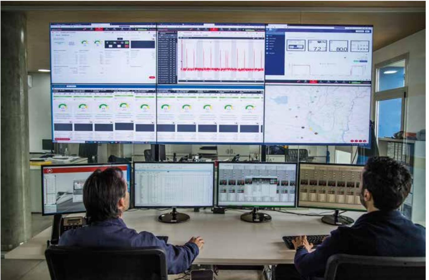
La Plataforma Digital Aercom 4.0 permite la telemetría de variables del funcionamiento de un grupo electrógeno o compresor de aire, posibilitando así el control predictivo y envío de alarmas en tiempo real. Este dispositivo permite la supervisión y monitoreo de una o varias centrales de grupos electrógenos y compresores de aire mediante aplicación dedicada, sobre una conexión seleccionable Ethernet o 3G-GSM/GPRS/EDGE.
