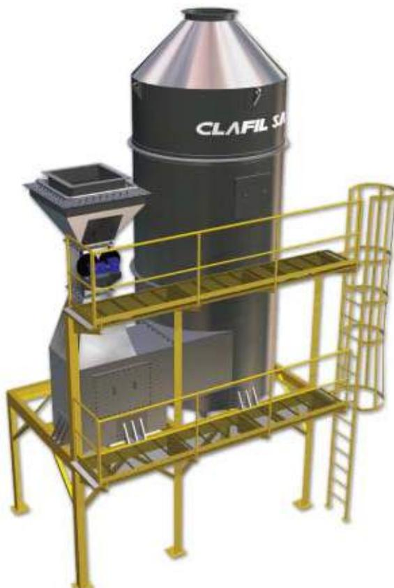
formando nuevas partículas de mayor tamaño que son fácilmente separadas en el ciclón separador. Finalmente la corriente gaseosa atraviesa un separador de gotas eliminando el líquido remanente (nieblas), abandonando el gas limpio el equipo por la parte superior. La mezcla de polvo líquido es descargado en el fondo del separador.
