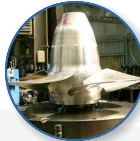
Torno Vertical Rotor Turbo Compresor Diámetro 1800 mm
