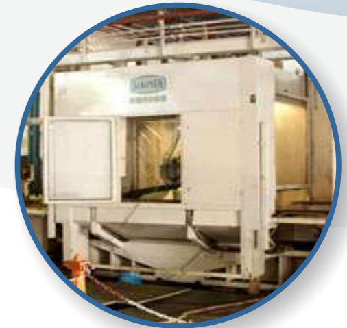
Centro de Mecanizado Mauser Horizontal 1000 x 1000 x1500 mm de trabajo
