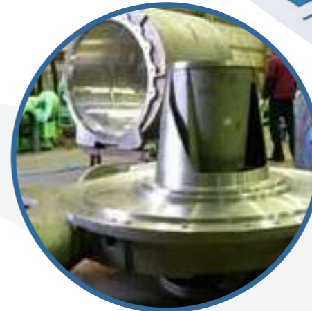
REPARACION DE BOMBA DE VACIO NASH CELULOSA ARGENTINA
