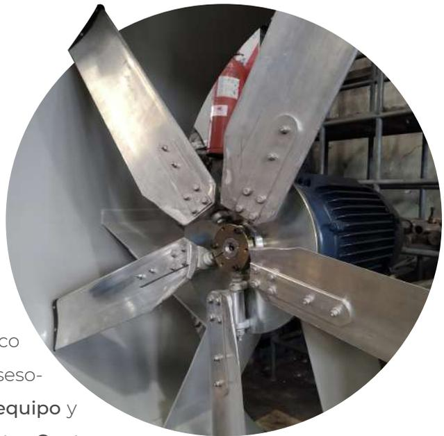
Hélices a paso variable estático y automático en aluminio extruido o fundido. Incluimos asesoramiento previo en materia de **cálculo del equipo** y el **desarrollo de curvas de comportamiento**. Contamos con un **túnel de viento** para el análisis aerodinámico de diversos perfiles de pala para conseguir la mejor solución para su aplicación. Bajo la marca ARFANS contamos con más de 9000 hélices instaladas en el mercado, rotando algunas desde hace 35 años.
